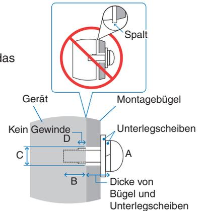
**HINWEIS:** Bei der Verwendung in einer Videowand über einen längeren Zeitraum können sich die Monitore aufgrund der Temperaturänderungen leicht ausdehnen. Es empfiehlt sich, zwischen angrenzenden Monitorkanten einen Spalt von mehr als einem Millimeter vorzusehen.
