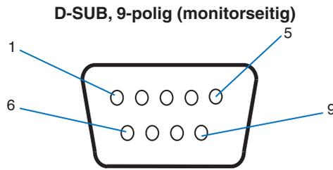
Dieser Monitor verwendet RXD-, TXD- und GND-Leitungen für die RS-232C-Steuerung.
